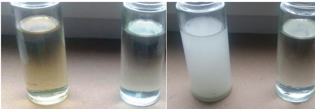
Внешний вид исходной и обработанной дизельной фракции при температуре +20°С и минус 38°С
